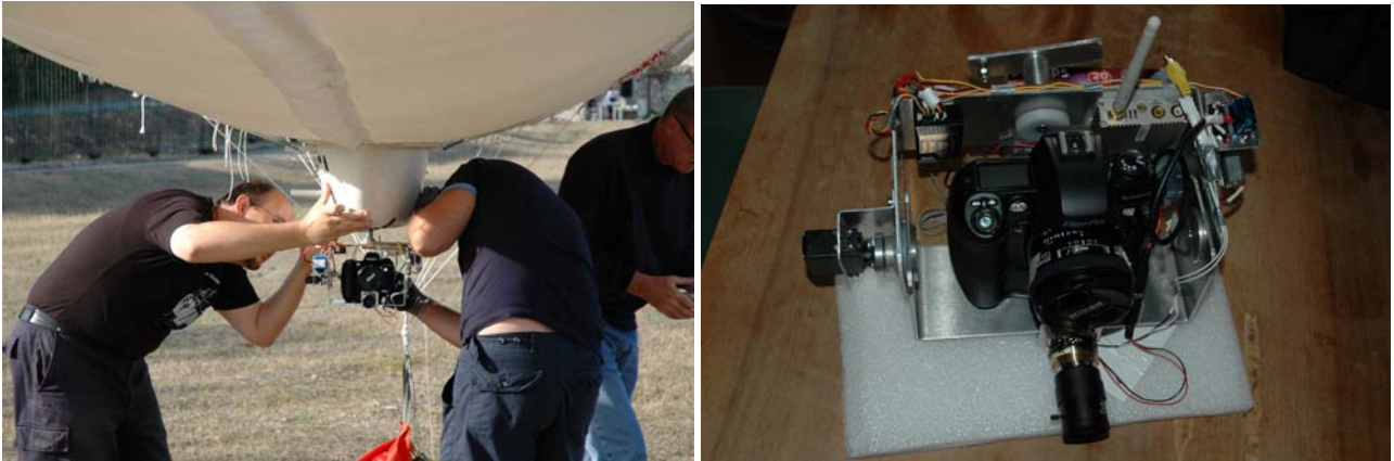
fig. 5 Il sistema di ancoraggio e controllo della camera digitale al pallone frenato
